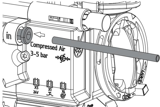
**i** Zum Abziehen des Druckschlauches vom Mundspülbeckenventil schwarze Muffe am Druckluftanschluß nach innen drücken.
