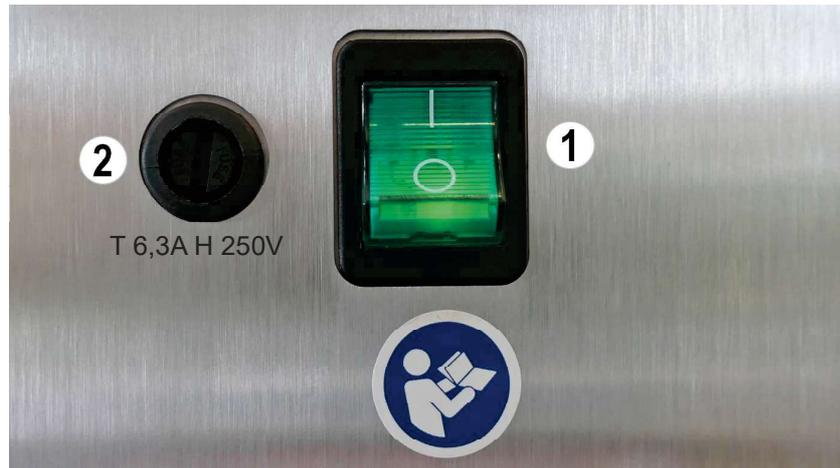
Die Behandlungseinheit verfügt über einen Netzschalter ① an der Stuhlbasis. Der Netzschalter verbindet die Behandlungseinheit mit dem Stromnetz. Bei längeren Standzeiten sollte die Behandlungseinheit vom Stromnetz getrennt werden.
