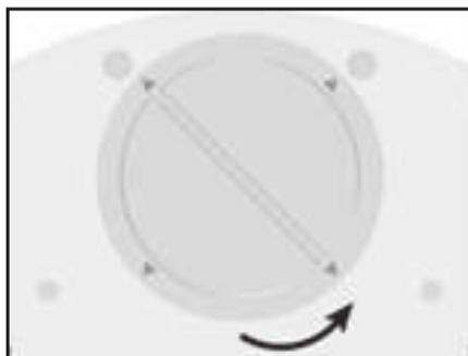
❶ Öffnen Sie das Batteriefach.
