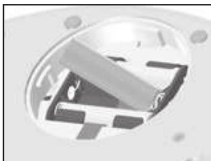
Positionieren Sie den roten Faden vor dem Einlegen der Batterie.
